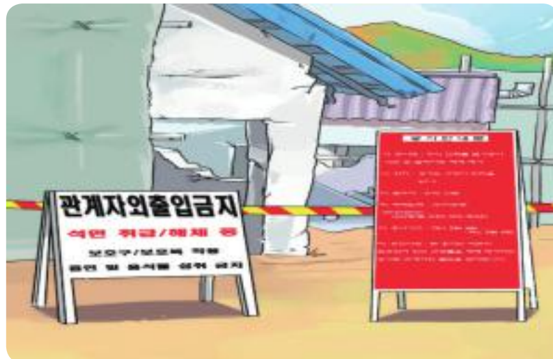
[그림 5] 석면해체·제거 작업장 바리케이트 및 경고표지 설치 예
